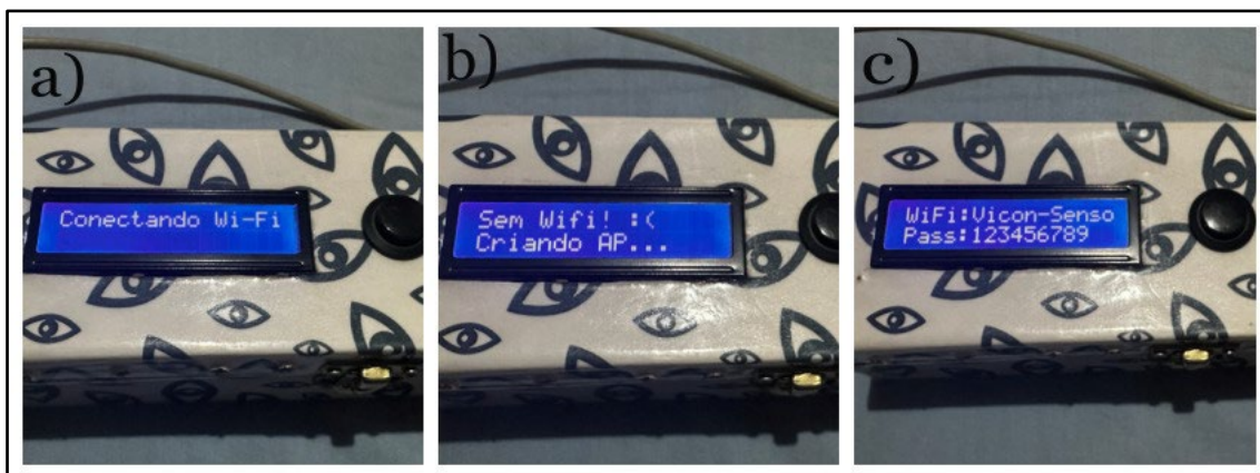
Figura 22 – QualiAr no processo de conexão ao Wifi. a) Tentando conectar a alguma rede; b) gerando um AP; c) disponibilizando nome do AP e senha para conexão.
