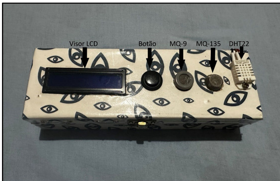
Figura 18- QualiAr mostrando display, botão e os 3 sensores.
