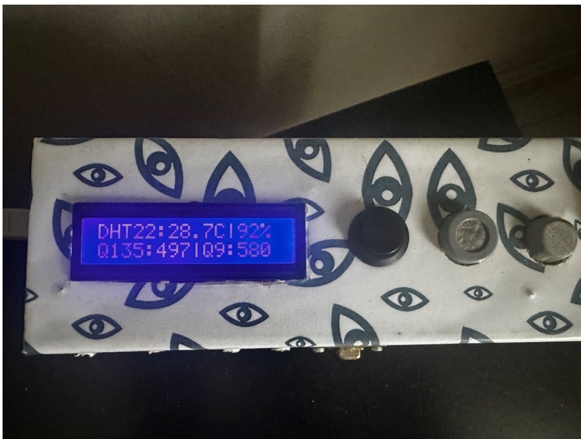
Figura 32 – QualiAr em funcionamento, sensor DHT22 para temperatura e umidade. Q135 e Q9 são os sensores MQ-135 e MQ-9, respectivamente.
