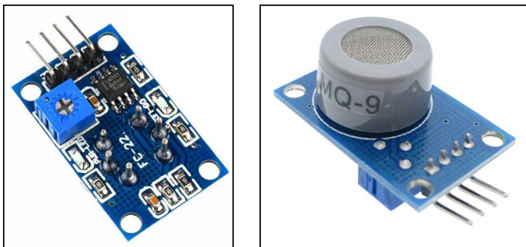
Figura 17 – Módulo MQ-9 a esquerda com o regulador de ajuste fino; e a direita o sensor externo.
