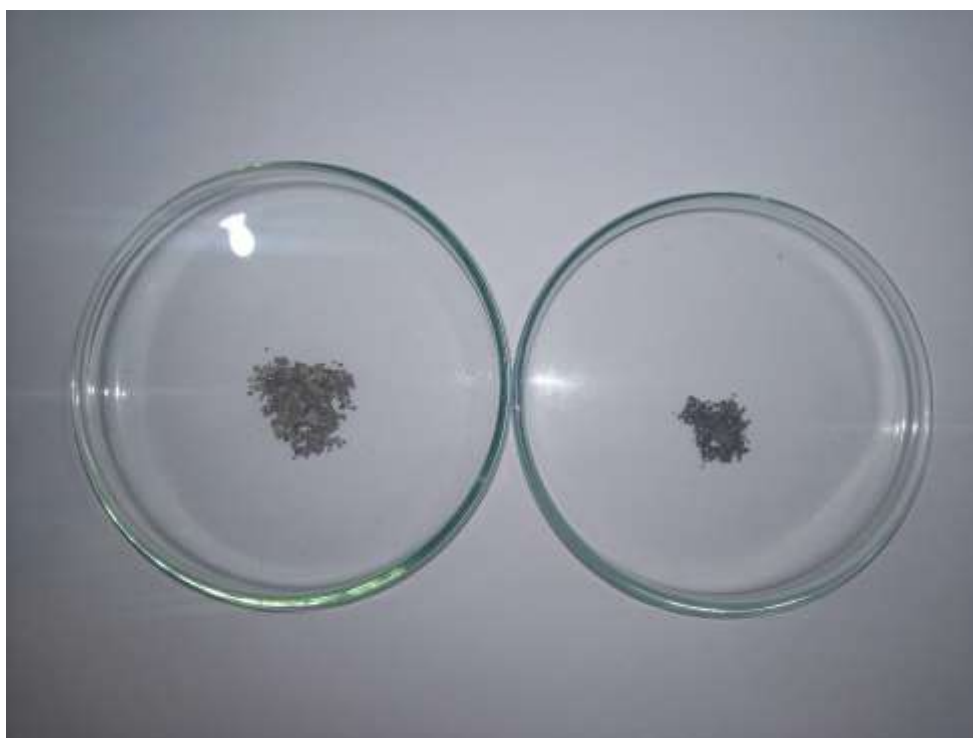
Figura 6. Separação inicial das amostras de calha com base em suas propriedades magnéticas. As frações magnéticas e não magnéticas foram dispostas em diferentes placas de Petri a fim de serem analisadas separadamente em etapa posterior.
