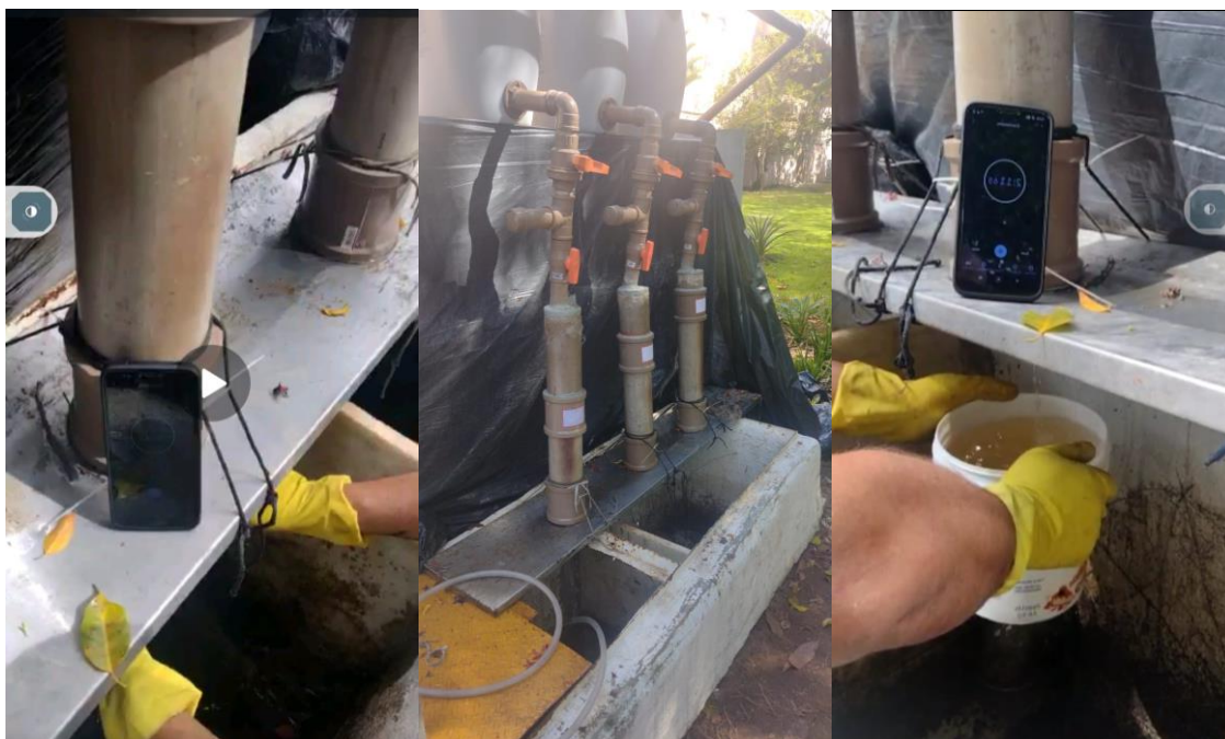
Figura 10 – Medição de vazão do sistema de filtros no campo – ETE BAYSIDE. (Fonte: Autor)
