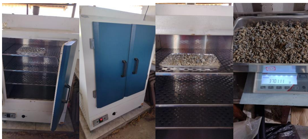
Figura 04 – Lithothamnium Calcareum levado a estufa, seco e pesado. (Fonte: Autor).
