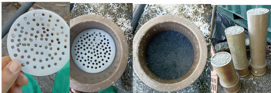
Figura 07 – Montagem do filtro com Lithothamnium Calcareum .
