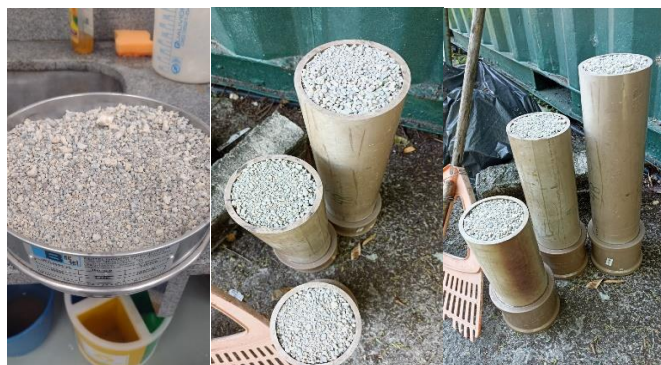
Figura 06 – Característica do material moído e classificado na faixa granulométrica de 1,00 a 4,75 mm. (Fonte: Autor).
