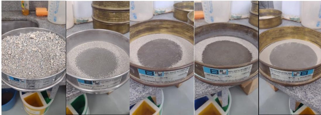
Figura 05 – Sistema de peneiras para classificação do material moído (Fonte: Autor).
