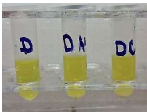
Figura 20. Análise da basicidade utilizando o indicador 2,4-nitroanilina: D – solução indicadora, DN – solução indicadora e cal in natura e DC – solução indicadora e cal termicamente tratada.
