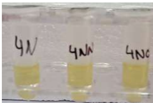
Figura 21. Análise da basicidade utilizando o indicador 4-nitroanilina: 4N – solução indicadora, 4NN – solução indicadora e cal in natura e 4NC – solução indicadora e cal termicamente tratada
