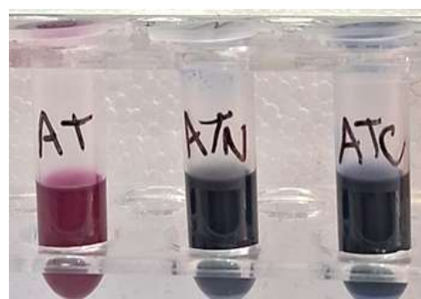
Figura 18. Análise da basicidade utilizando o indicador azul de timol: A – solução indicadora, ATN – solução indicadora e cal in natura e ATC – solução indicadora e cal termicamente tratada.
