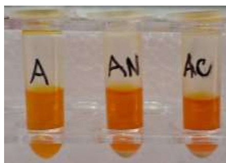
Figura 15. Análise da basicidade utilizando o indicador amarelo de dimetila: A – solução indicadora, AN – solução indicadora e cal in natura e AC – solução indicadora e cal termicamente tratada.
