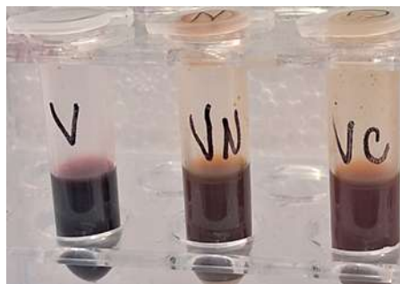
Figura 17. Análise da basicidade utilizando o indicador amarelo neutro: V – solução indicadora, VN – solução indicadora e cal in natura e VC – solução indicadora e cal termicamente tratada.
