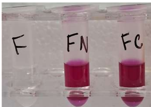
Figura 19. Análise da basicidade utilizando o indicador fenolftaleína: F – solução indicadora, FN – solução indicadora e cal in natura e FC – solução indicadora e cal termicamente tratada.
