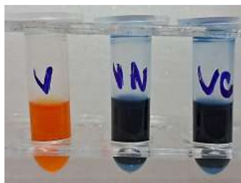
Figura 16. Análise da basicidade utilizando o indicador Verde de bromocresol: V – solução indicadora, VN – solução indicadora e cal in natura e VC – solução indicadora e cal termicamente tratada
