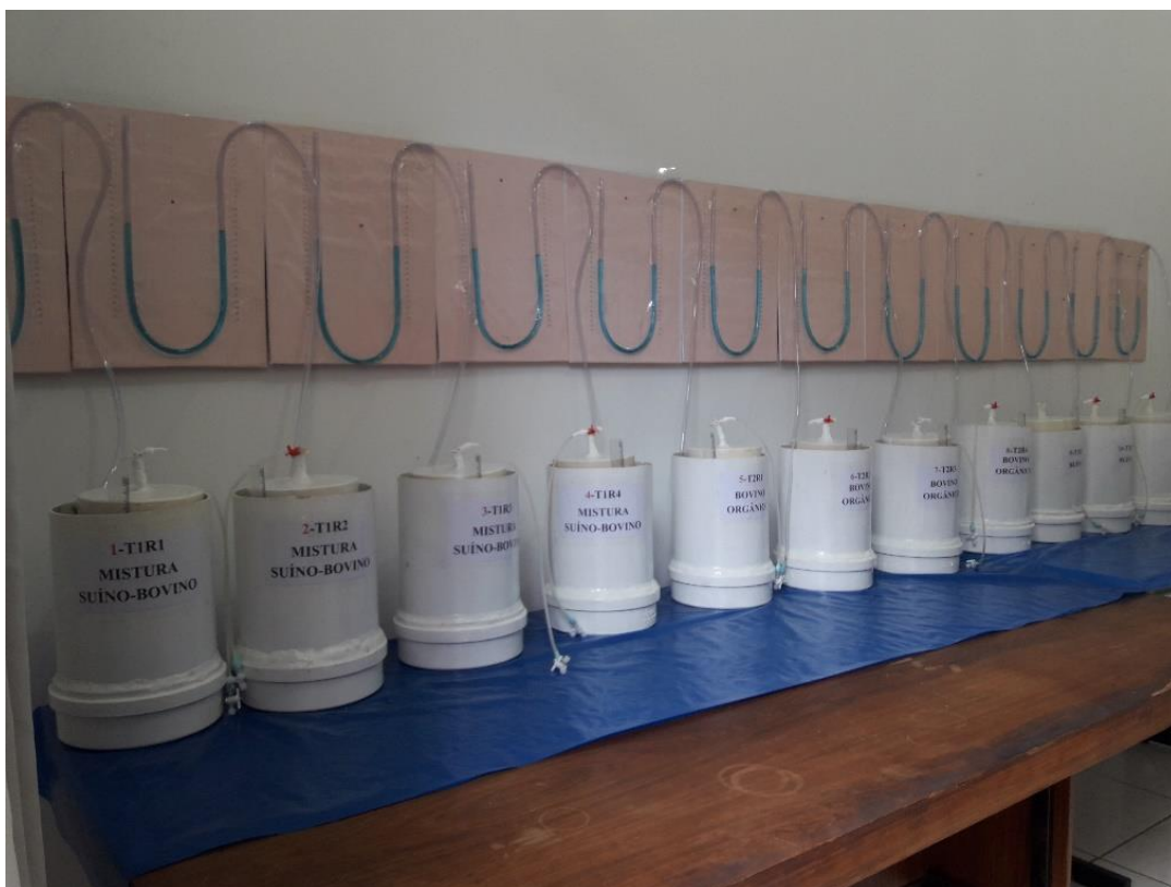
Figura 22. Protótipos de biodigestores abastecidos com dejetos suínos, bovinos e a mistura de suínos com bovinos.
