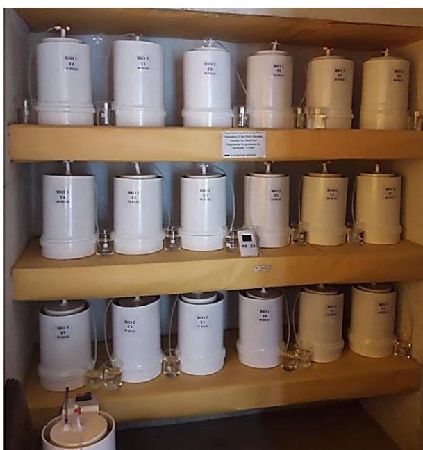
Figura 2. Protótipos de biodigestores de bancada abastecidos com dejetos bovinos em diferentes TRH.
