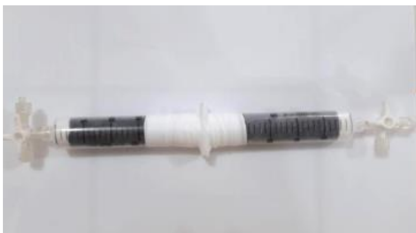
Figura 23. Filtro de biogás para a remoção de H_2S no gás coletado.
