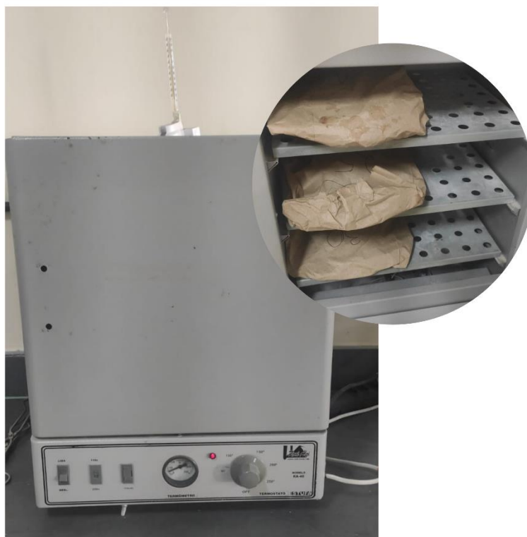
Figura 10. Estufa utilizada para secagem da massa fresca.
