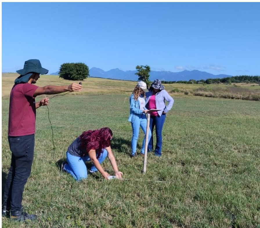
Figura 7. Aferição do IAF com o ceptômetro.
