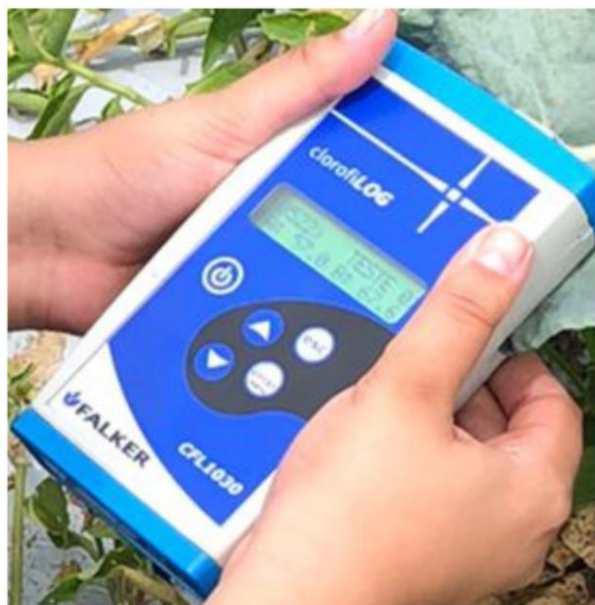
Figura 8. Clorofilômetro utilizado para mensuração de clorofila.
