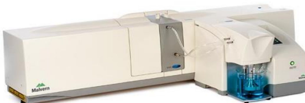
Figura 3. 19 Granulômetro a Laser Mastersizer 2000. Fonte: Catálogo MALVERN (2017).
