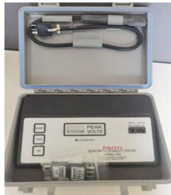
Figura 2.7. Medidor de estabilidade elétrica FANN 23D. Fonte: Adaptado da Web FANN.
