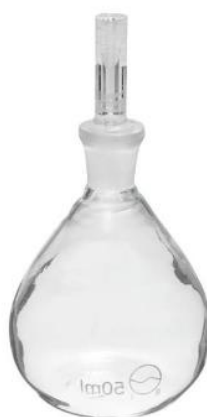
Figura 3.20. Picnômetro de 50 ml. Fonte: Catálogo AZEHEB Laboratórios (2023).
