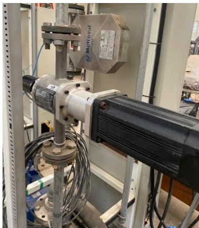
Figura 3.8. Viscosímetro tubular Brookfield modelo TT-100. Fonte: Autor, 2024.
