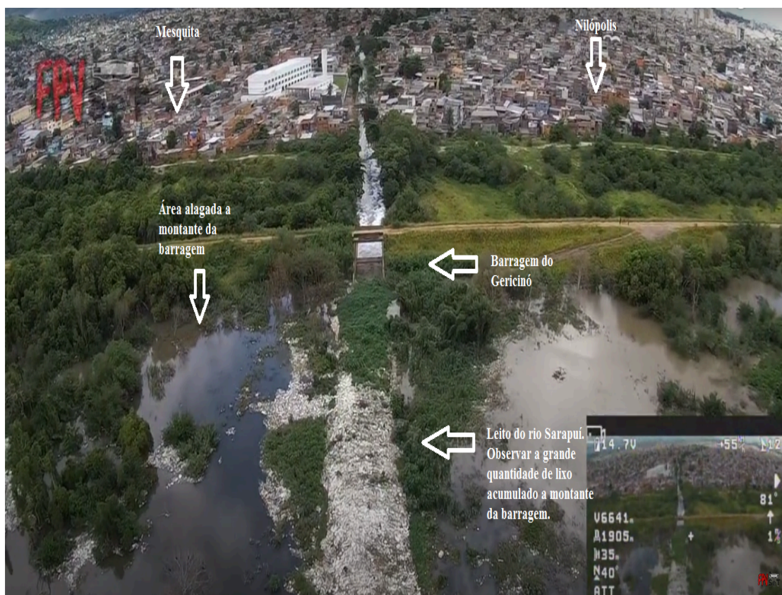
Figura 12: Imagem aérea obtida por drone mostrando um período de alagamento após período de chuvas intensas. Observar que a barragem, neste episódio de enchente, conseguiu manter a água extravasada do leito do rio Sarapuí, evitando, desta forma, que as áreas densamente ocupadas a jusante da barragem fossem alagadas.
