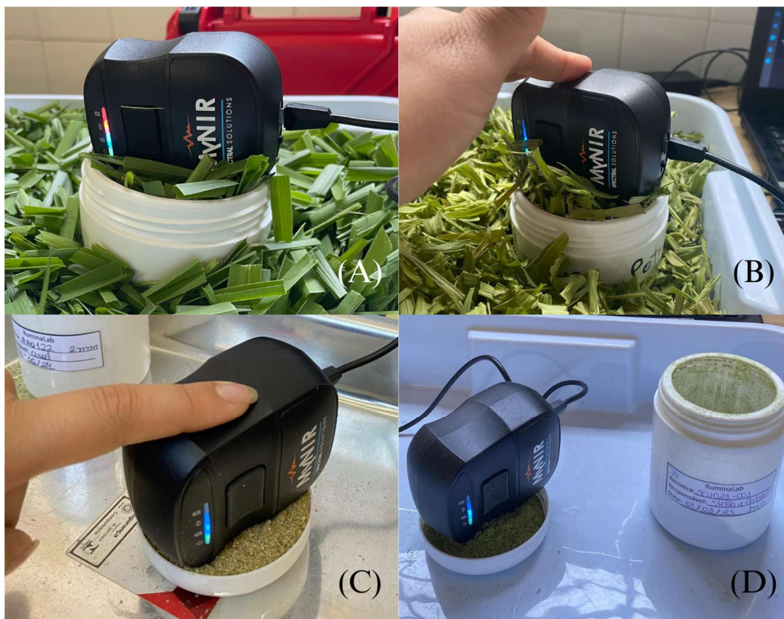
Figura 1. Coleta das amostragens espectrais nos 4 graus de processamento de amostra: (A) fresca; (B) seca; (C) seca e moída a 2 mm; (D) seca e moída a 1 mm.
