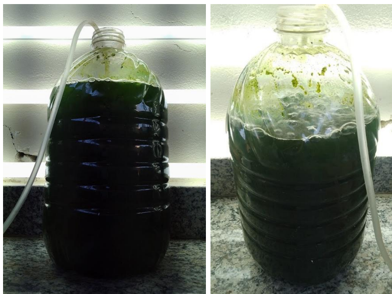
Figura 13. Fotobiorreator utilizado no cultivo da microalga Chlorella vulgaris . Fonte: a autora (2025).
