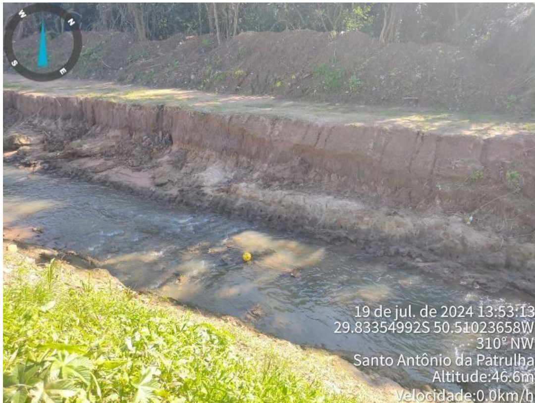
Figura 5 - imagem obtida in loco da área de estudo onde é possível observar o agravamento do processo de erosão. Localizada na rua Lottar Machado dos Reis, nas margens do arroio Passo dos Ramos em Santo Antônio da Patrulha (RS). Foto de 2024.
