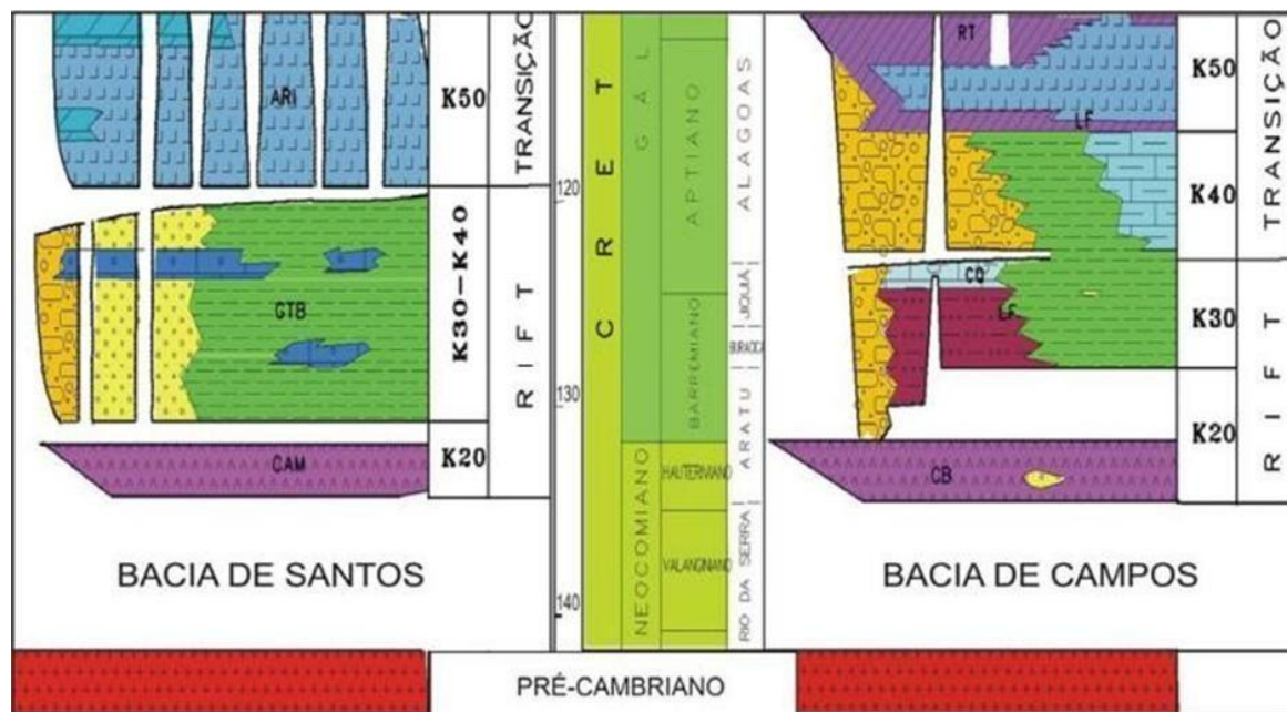
Figura 6 Correlação cronoestratigráfica entre as bacias de Santos e Campos. Fonte: modificado de Moreira et al., 2007; Thomaz Filho et al., 2008). CAM = Formação Camboriú; CB = Formação Cabiúnas.
