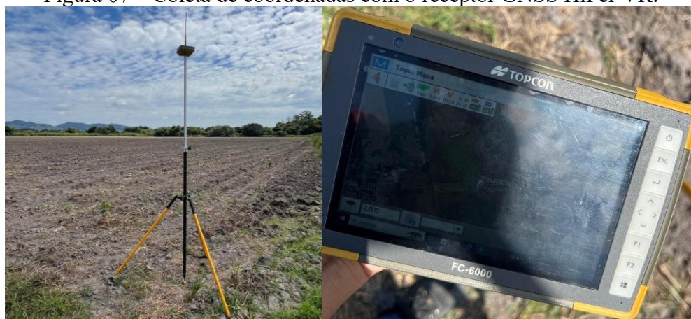
Figura 07 – Coleta de coordenadas com o receptor GNSS HiPer VR.
