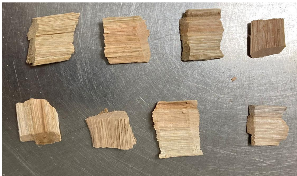
Figura 8 - Imagem demonstrando as frações granulométricas classificadas cavacos aceitos. Fonte: Próprio autor.
