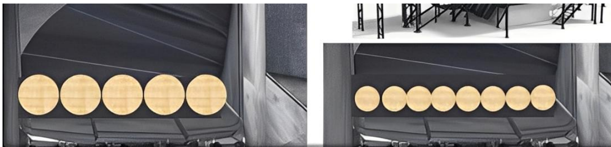
Figura 9 - Comparação da quantidade de toras, em diferentes VMIs, necessárias para ocupar a área de alimentação do picador.
