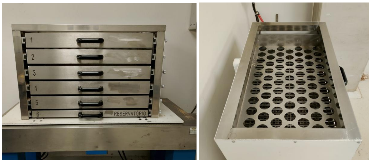
Figura 2 - Equipamento de classificação de cavacos utilizando peneiras vibratórias, onde: (a) detalhes da visão frontal do equipamento; e (b) detalhes das peneiras do equipamento onde os cavacos são alimentados.
