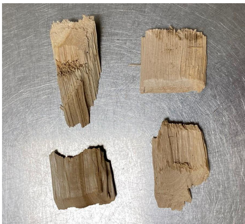
Figura 5 – Imagem demonstrando os cavacos classificados como overs. Fonte: Próprio autor.
