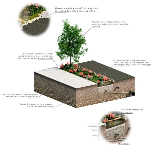
Figura 8 - Biovaleta. Perspectiva isométrica com detalhe. Fonte: GUAJAVA, ET AL (2023, p. 68).
