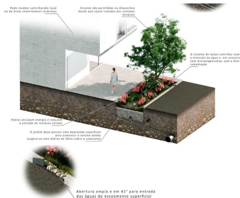
Figura 7 - Canteiro Pluvial. Perspectiva isométrica com detalhe. Fonte: GUAJAVA, ET AL (2023, p. 56)
