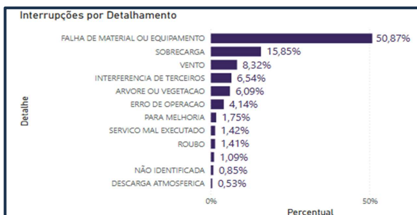
Figura 21 – Interrupção por detalhamento (conjunto Monte Azul) (Abradee 2024)
