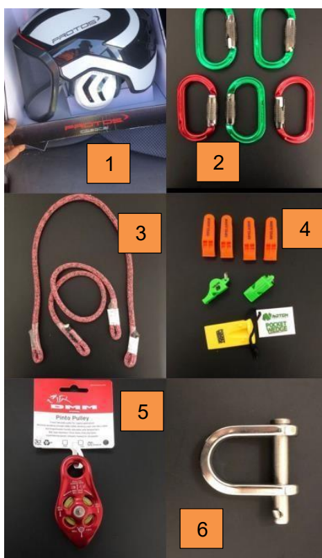
Figura 5 – 1- Capacete; 2 – Mosquetão Tripla trava; 3- Cordelete; 4-Apito de salvamento; 5- polia pinto; 6- Manilha reta com pino
