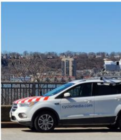
Figura 13 – veículo de varredura LiDAR (Light Detection and Ranging). Fonte: Trees Count Registration : NYC Parks
