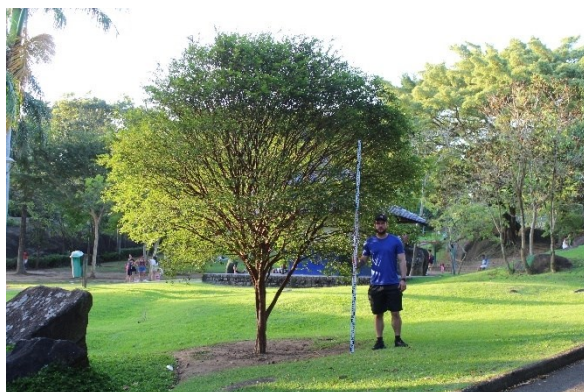
Figura 13: Medição da altura utilizando régua telescópica de 3 m como gabarito. Fonte: Elaborado pelo autor.
