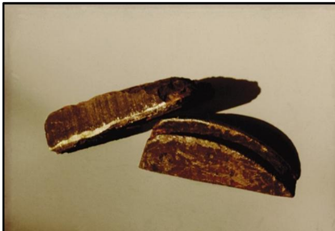
Figura 16 - Corrosão Grafítica: a parte escura é devido ao carbono que se separou da estrutura de ferro fundido que sofreu oxidação.
