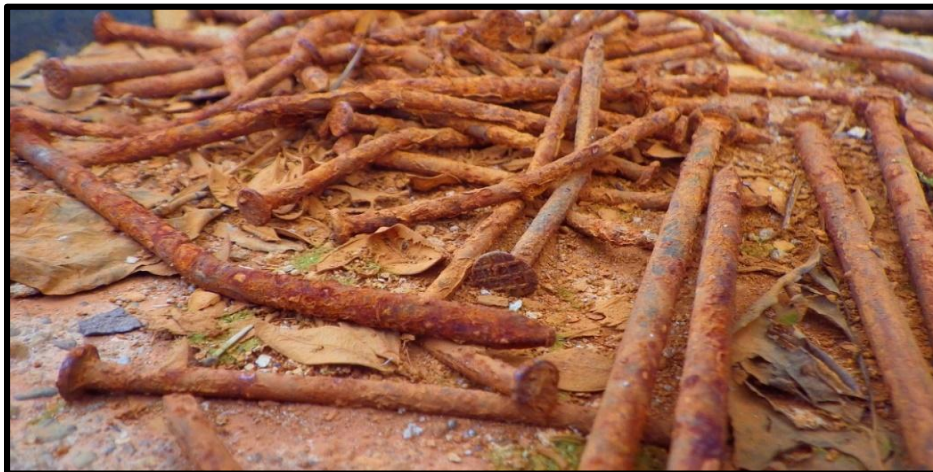
Figura 9 - Óxido de ferro hidratado, popularmente conhecido como ferrugem, formado na superfície metálica desprotegida.
