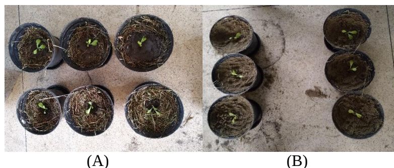
Figura 4. Piloto de vasos em sistema de verdeponia com presença e ausência de núcleo de solo (A), vasos após adição da camada superficial de areia lavada (B).
