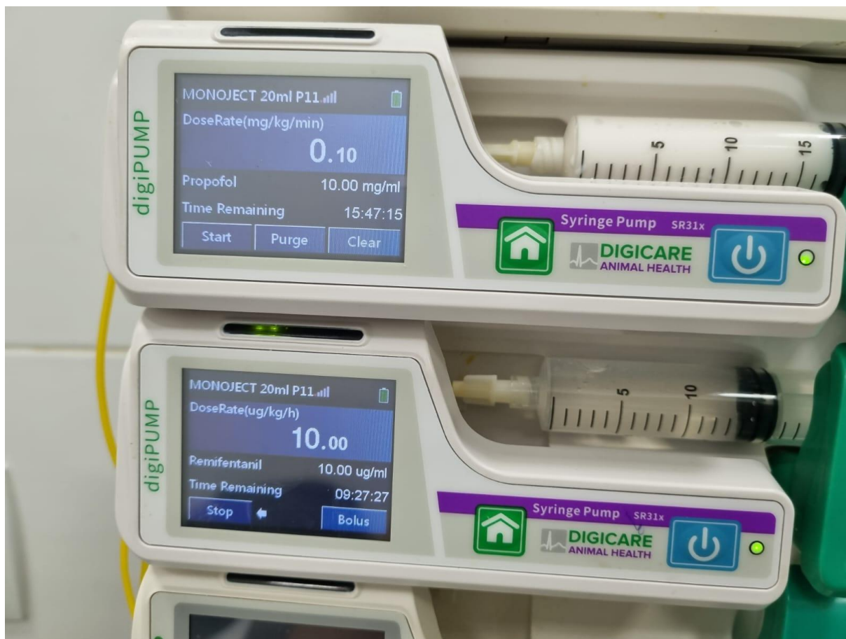
Figura 10 - bombas de infusão de seringa da marca Digicare, linha Animal Health, modelo digiPUMP SR31x. Fonte: Foto do autor
