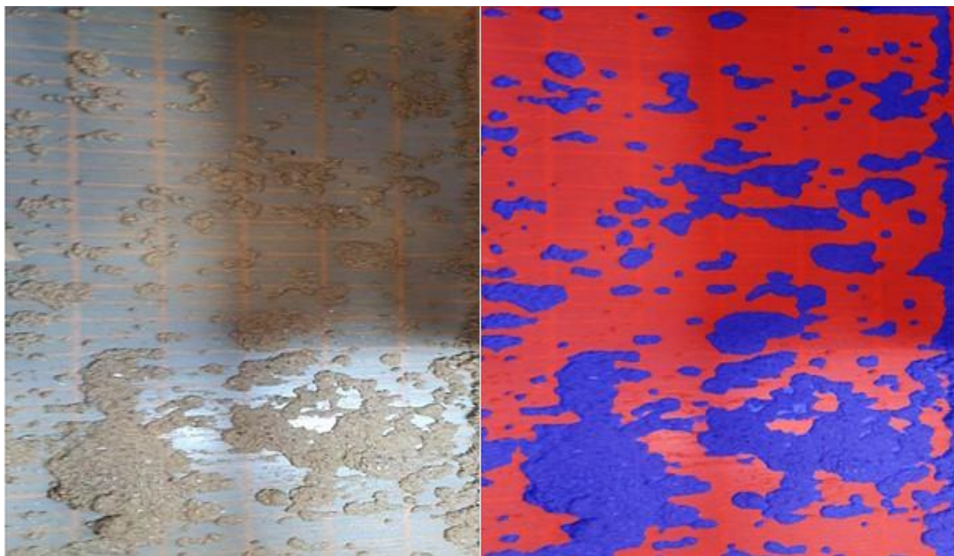
Figura 4.3. Resultado da segmentação da suspensão na peneira: (a) imagem original adquirida durante o experimento; (b) máscara de segmentação gerada pela U-Net, evidenciando as regiões classificadas como suspensão.
