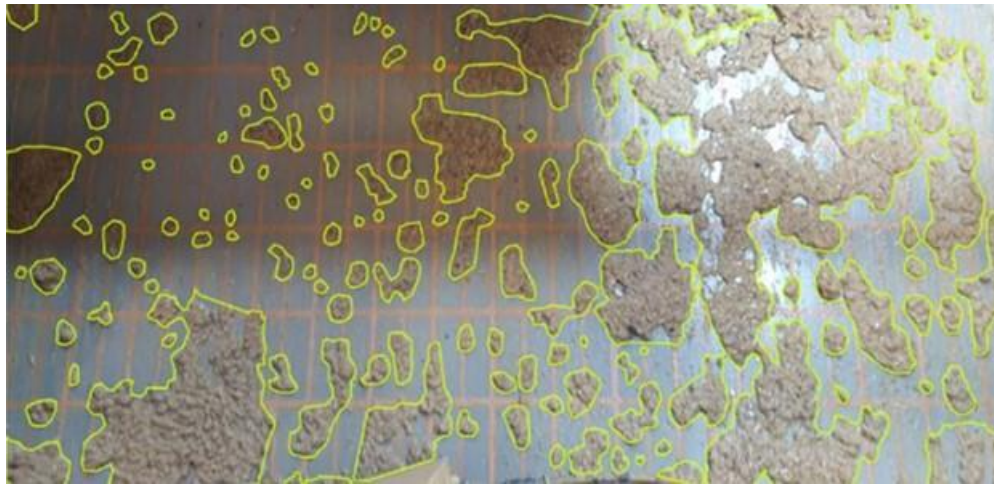
Figura 3.4 - Exemplo de uma segmentação no Roboflow (polígonos amarelos - suspensão) do experimento realizado na UFU em 1200 RPM e 20 m 3 /h.
