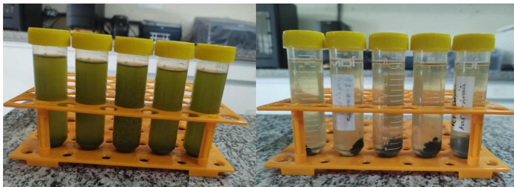
Figura 6. Biofertilizante de microalgas antes e depois da centrifugação para obtenção da biomassa concentrada com retirada de 97,78% da solução sobrenadante.
