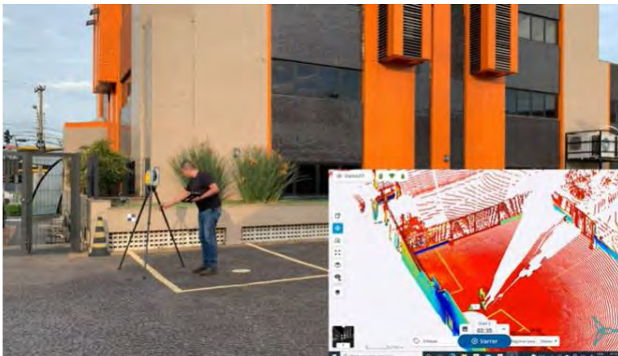
Figura 29: Utilização de laser scanner em campo, com geração automática de nuvem de pontos
