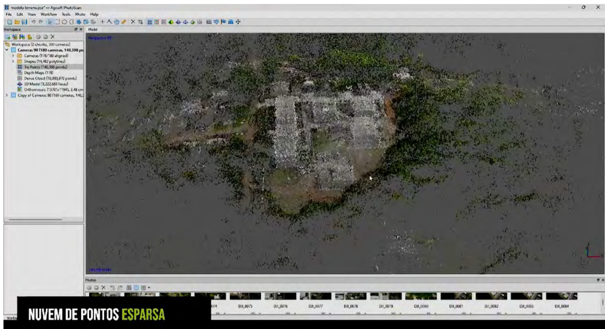
Figura 25: Ilustração da nuvem de pontos esparsa que é gerada a partir do levantamento fotogramétrico
