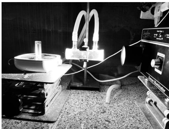
Figura 12. Esquema para a reação de fotodegradação empregando o Iluminador Xenon Luzchem LUZ-XE-PV, equipado com uma lâmpada de xenônio de 300W.
