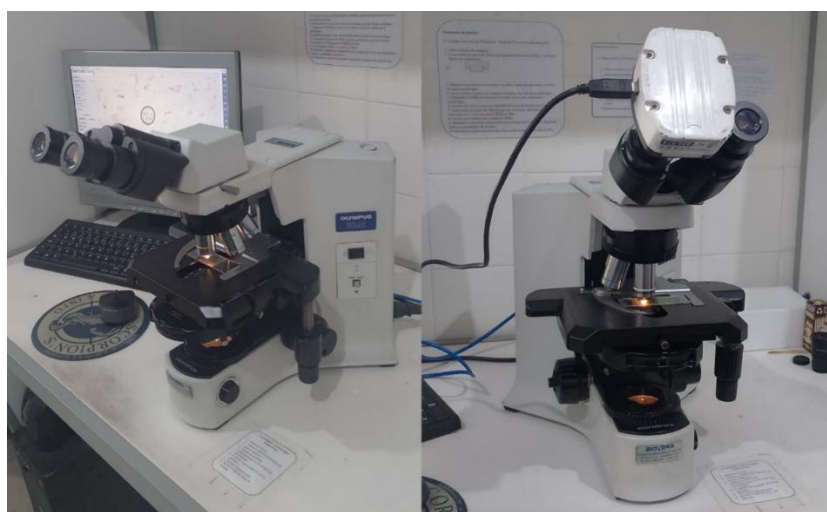
Figura 16 – Microscópio óptico equipado com câmera digital para realização de fotomicrografias.
