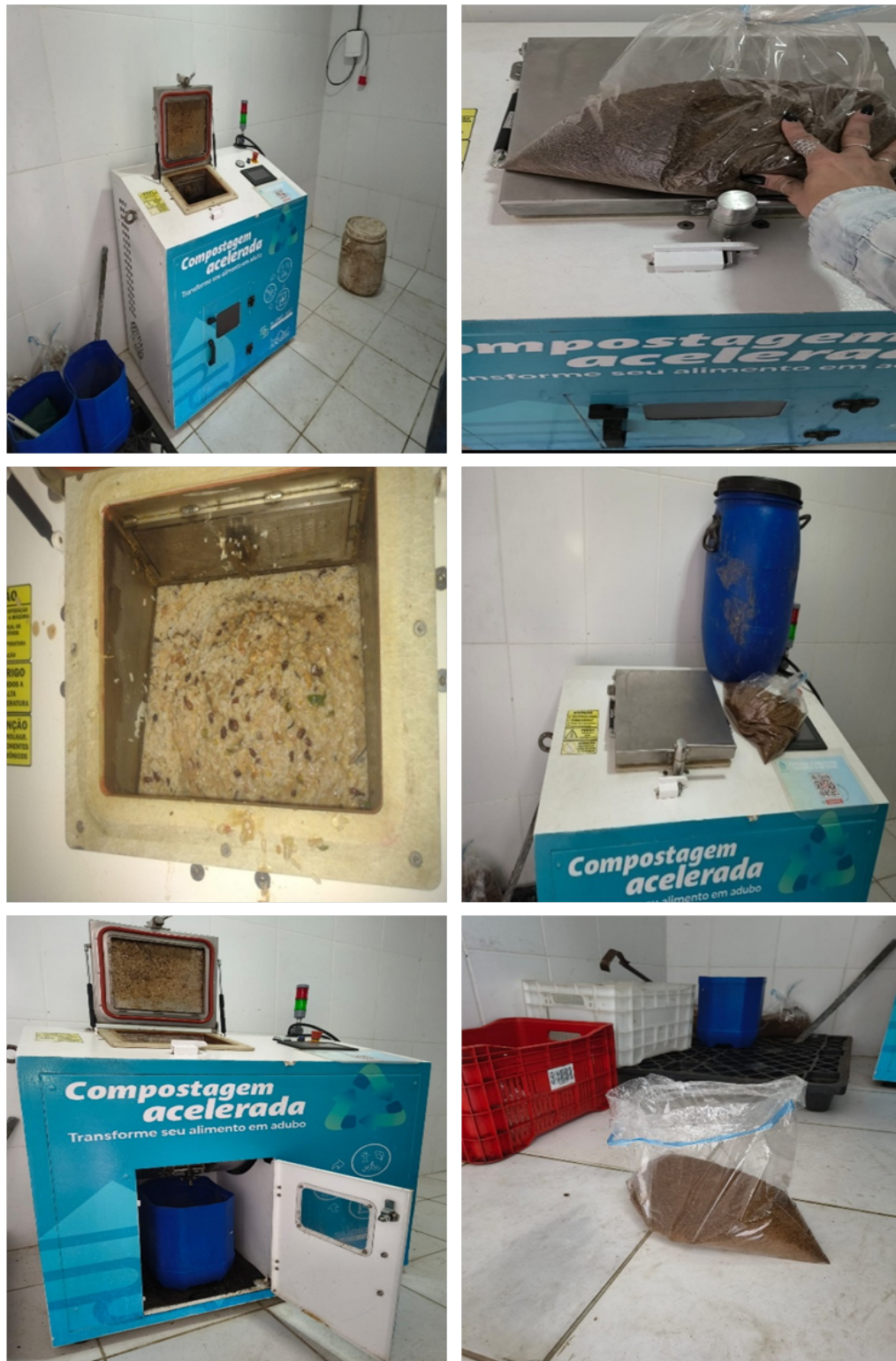
Figura 24. Protótipo de sistema de compostagem acelerada utilizado como projeto piloto no Restaurante Universitário da UFRRJ.
