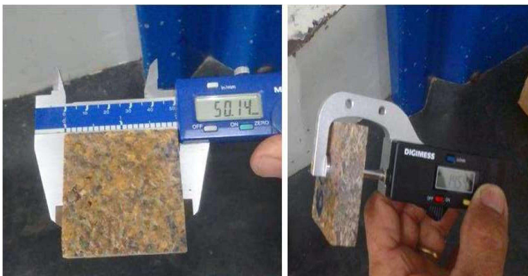
Figura 19. Esquema de medição das dimensões dos corpos de prova: largura (B) obtida com paquímetro digital e espessura medida no ponto de intersecção das diagonais com micrômetro digital.
