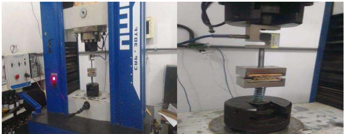
Figura 24. Corpos de prova colados aos suportes durante ensaio de tração perpendicular.
