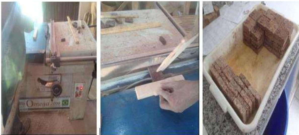
Figura 17. Corpos de prova para avaliação das propriedades dos painéis. Fonte: o autor (2025)
