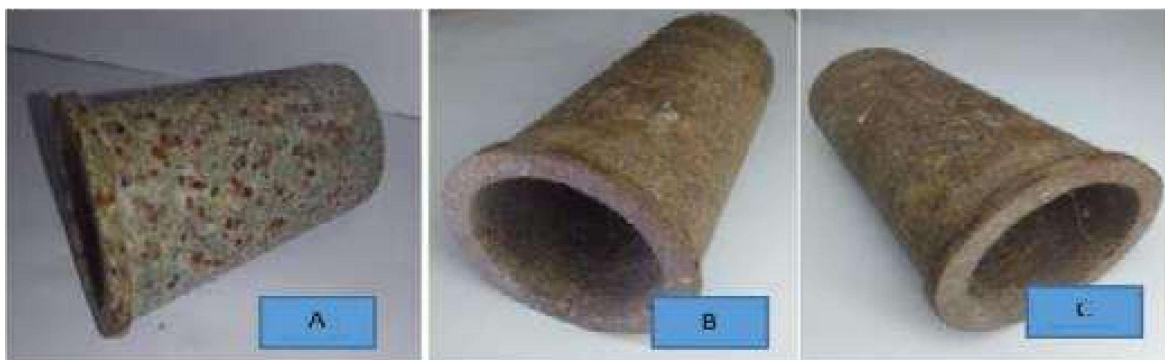
Figura 27 - A, B e C. tubetes com diferentes formulações, onde utilizamos a Resina de Mamona bicomponentes.
