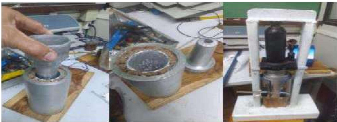
Figura 13. Prensagem utilizando a prensa hidráulica. Moldes utilizados para a fabricação dos tubetes e dimensões após moldagem.
