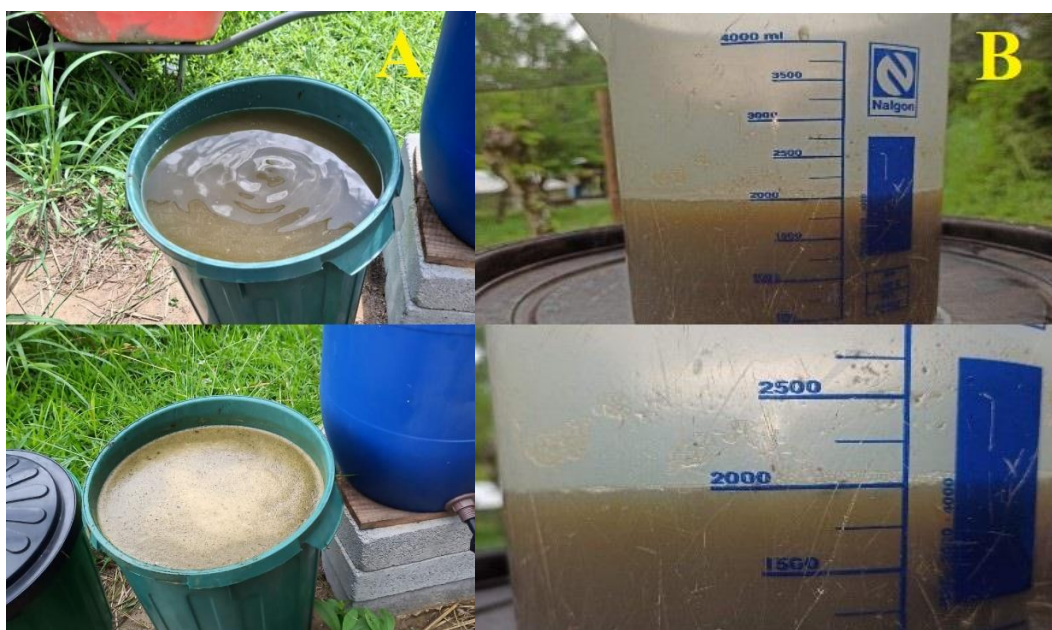
Figura 11. (A) Aspecto visual da água residuária da bovinocultura antes e após o processo de homogeneização de 48 horas. (B) Aplicação de 2000 mL da mistura em cada unidade de wetland construído.
