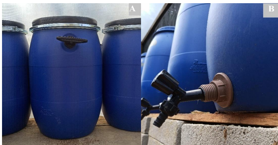
Figura 5. (A) Vista frontal das bombonas plásticas utilizadas como unidades experimentais (Ø 35 cm, altura 60 cm); (B) detalhe da torneira plástica instalada na base inferior para retirada dos efluentes.
