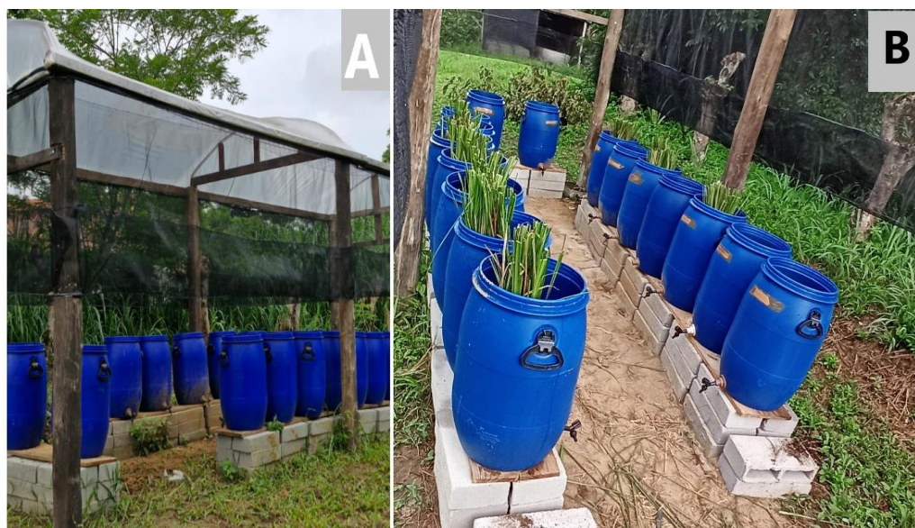
Figura 6. (A) Estrutura de suporte construída para instalação dos sistemas de wetlands construídos de fluxo vertical dentro da casa de vegetação. (B) Bombonas posicionadas sobre a estrutura, permitindo elevação adequada e facilitando o manejo experimental.
