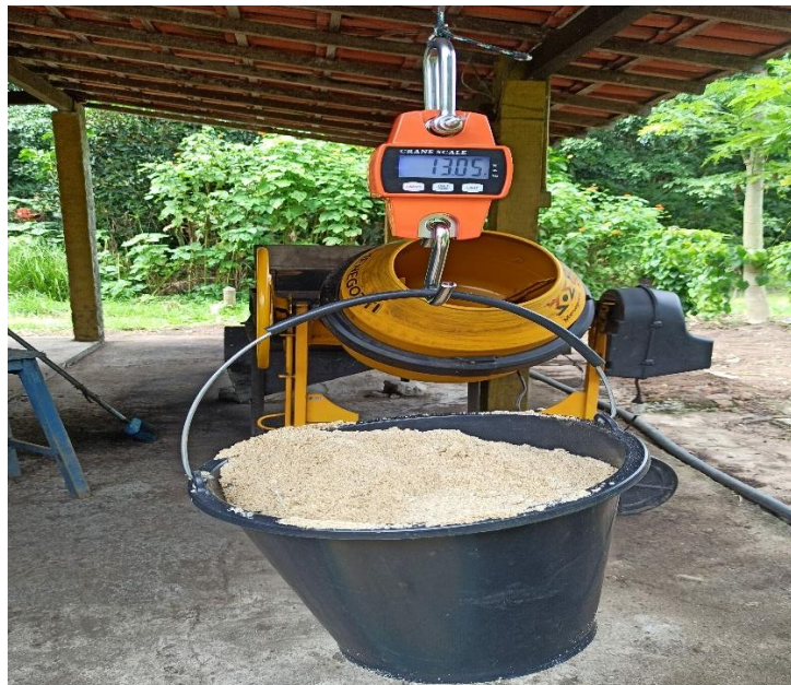
Figura 8. Betoneira utilizada na mistura da areia com o granulado bioclástico de Lithothamnium calcareum .
