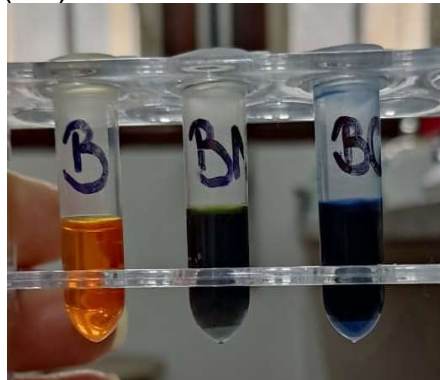
Figura 13 - Ensaio de basicidade com o indicador Verde de bromocresol (B) para dolomita in natura (BN) e dolomita termicamente tratada (BC)
