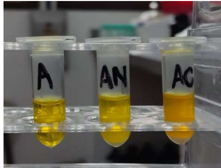
Figura 12 - Ensaio de basicidade com o indicador Amarelo de dimetila (A) para dolomita in natura (AN) e dolomita termicamente tratada (AC)
