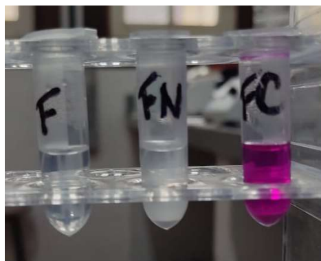
Figura 15 - Ensaio de basicidade com o indicador Fenolftaleína (F) para dolomita in natura (FN) e dolomita termicamente tratada (FC)
