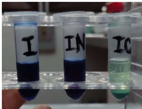
Figura 16 - Ensaio de basicidade com o indicador Índigo (I) para dolomita in natura (IN) e dolomita termicamente tratada (IC)
