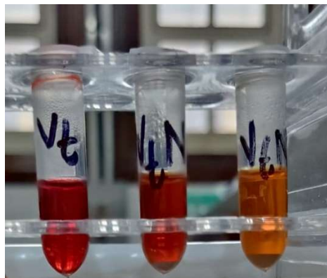
Figura 14 - Ensaio de basicidade com o indicador Vermelho neutro (Vt) para dolomita in natura (VtN) e dolomita termicamente tratada (VtC)
