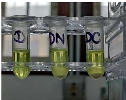
Figura 17 - Ensaio de basicidade com o indicador 2,4-dinitroanilina (D) para dolomita in natura (DN) e dolomita termicamente tratada (DC)
