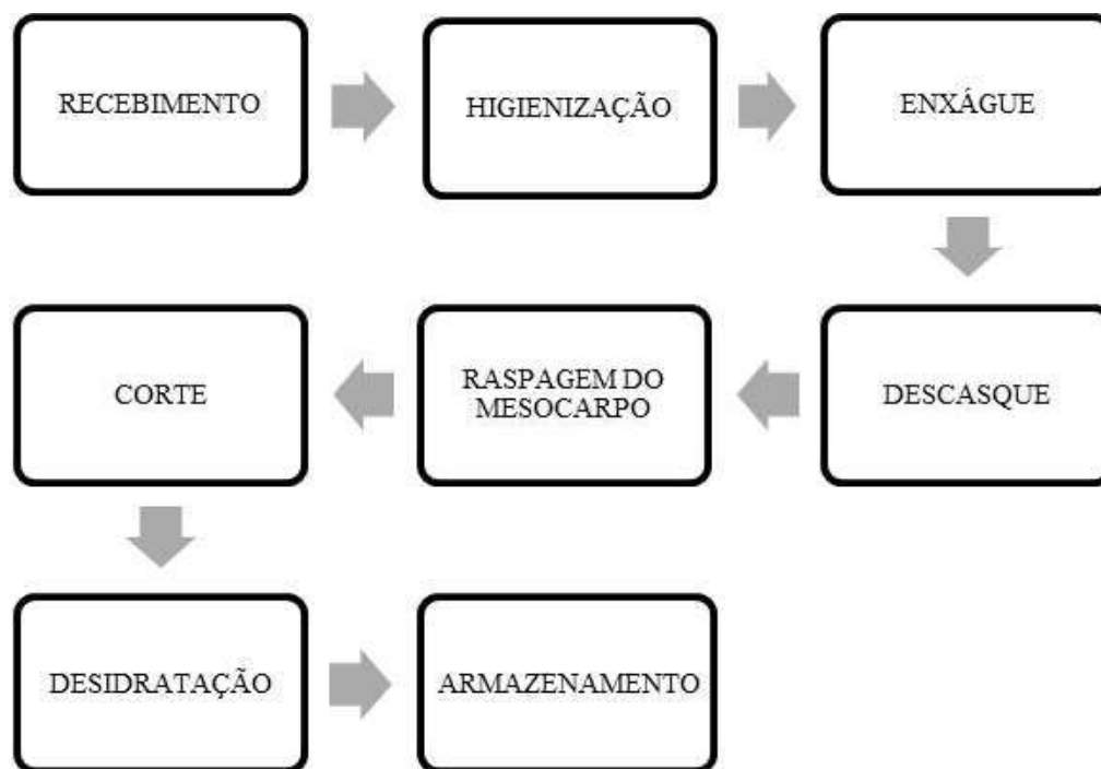
Figura 7. Fluxograma de beneficiamento de bananas desidratadas. Maricá - RJ, 2024.
