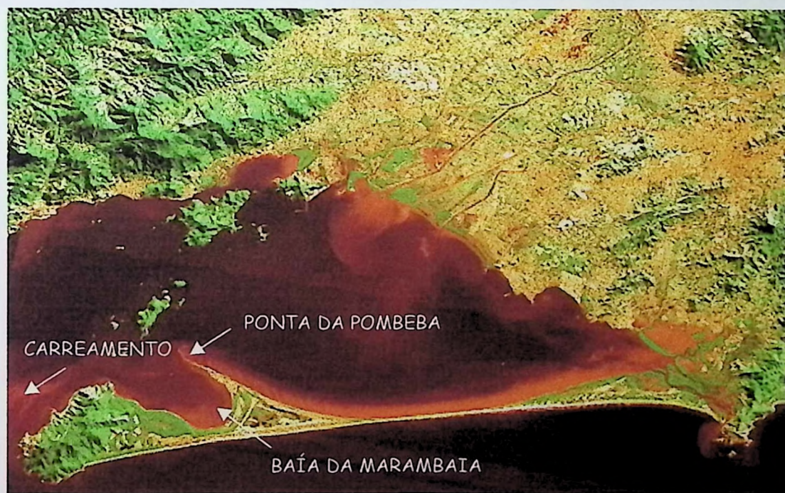
Figura 2. Dinâmica atual dos sedimentos na Baía de Sepetiba, indicando erosão da ponta da Pombeba e carreamento de sedimentos para fora da Baía.
