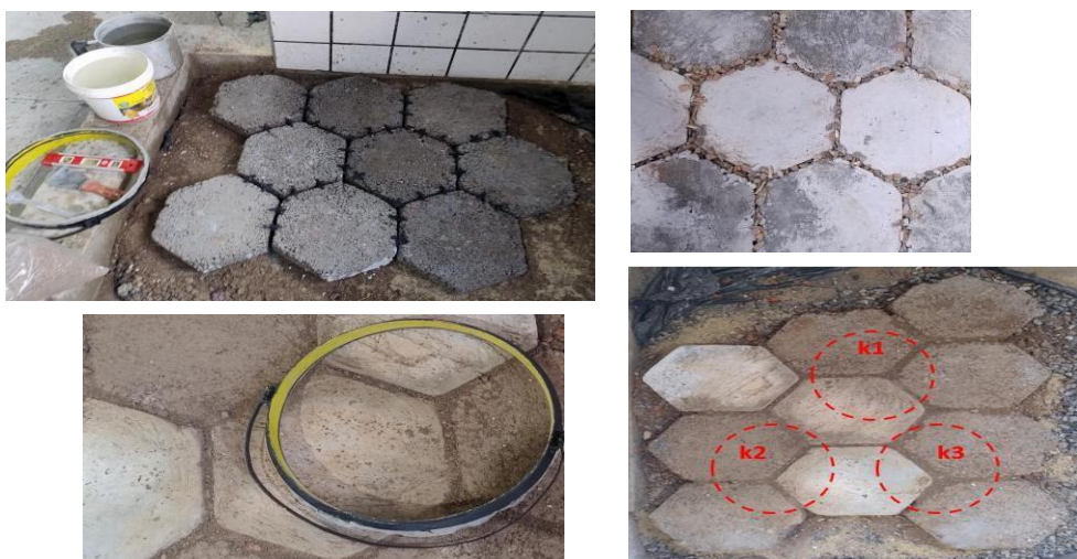
Figura 25 - Processo de assentamento dos pavers , a fixação do anel de infiltração, e os círculos vermelhos evidenciando o posicionamento dos anéis no conjunto de 9 peças para executar triplicata no ensaio.
