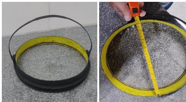
Figura 24 – Confeção do anel de infiltração e aferição das medidas para ensaio de coeficiente de permeabilidade.
