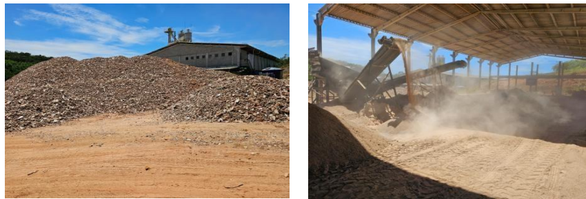
Figura 13 - RCC antes e depois do processo de beneficiamento.
