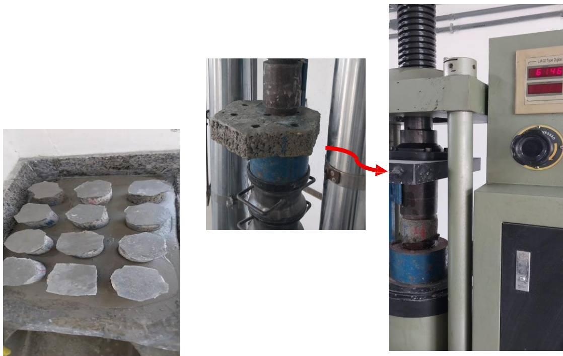
Figura 21 - Corpos de prova sendo capeado para o ensaio de resistência à compressão (à esquerda), e máquina de ensaio mecânica durante a compressão do concreto.
