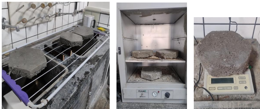
Figura 22 - Pavers em processo de secagem natural para obtenção da massa saturada (à esquerda), estufa para a secagem artificial (no centro) e pesagem (à direita)..
