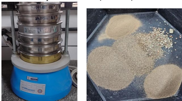
Figura 16 - Agitador de peneiras para ensaio granulométrico (à esquerda) e RCC após peneiramento (à direita).
