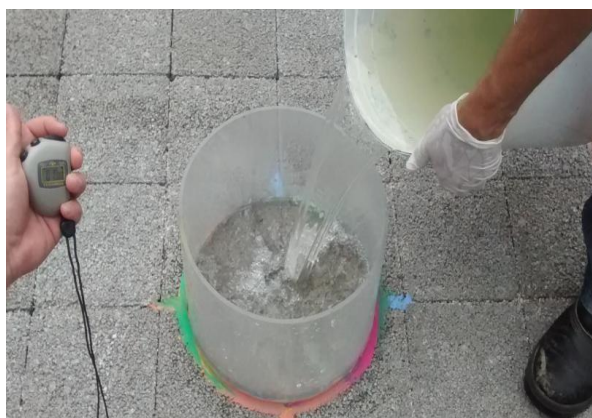
Figura 11 - Execução do ensaio de infiltração in situ baseado na ASTM C1701 / NBR 16416.
