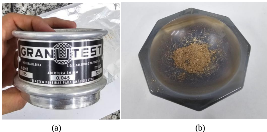
Figura 17 - Peneira com abertura de 0,045mm (a); Almofariz de ágata com RCC sendo preparado (b)..
