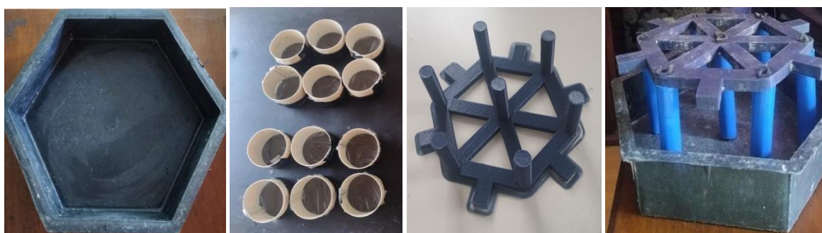
Figura 18 – Moldes e contramoldes para a conformação das peças hexagonais e cilíndricas.
