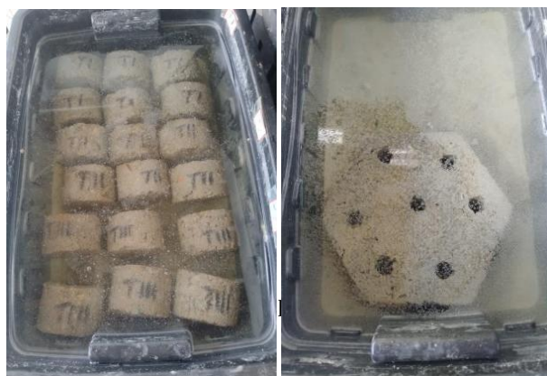
Figura 20 - Peças cilíndricas e sextavadas em processo de cura.
