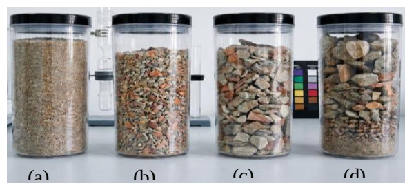
Figura 14 - RCC ao final do processo de beneficiamento. (a) Pó de Pedra; (b) Brita 1; (c) Cascalho; (d) Mistura.
