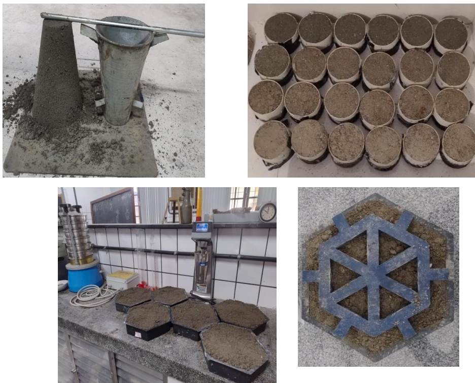
Figura 19 - Execução do Ensaio Tronco de Cone ( slump test ), e moldagem em forma cilíndrica, em forma sextavada, e sextavada com molde para furos.
