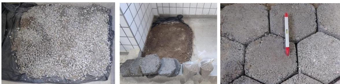
Figura 23 - Ensaio de permeabilidade dos pavers indicando as camadas de assentamento e nivelamento.
