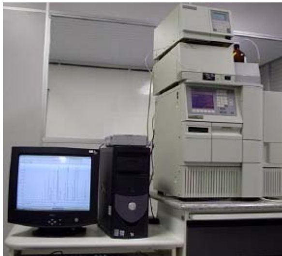
Figura 25: Sistema cromatográfico Waters Alliance 2695, utilizado no desenvolvimento e nas análises do método de determinação do teor de vitamina C.
