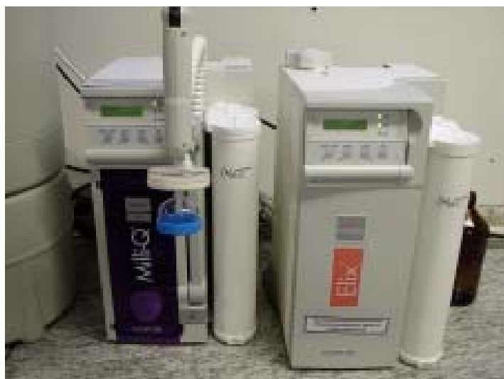
Figura 23: Sistema de purificação e ultra purificação de água utilizado no desenvolvimento e nas análises do método de determinação do teor de vitamina C.
