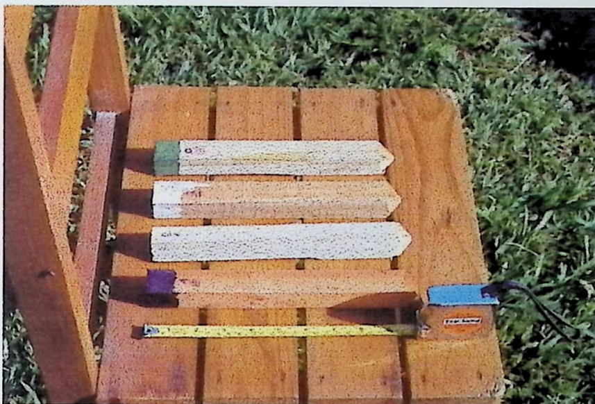
Figura 3. Estacas de madeira de quatro essências florestais ( Eucalyptus pellita , Pinus sp., E. robusta , E. urophylla ).
