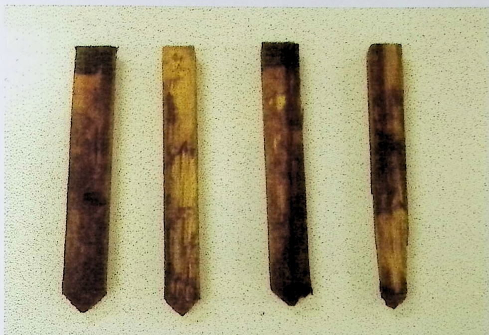
Figura 7. Amostras de Eucalyptus urophylla (ponta verde) e Pinus sp. (sem cor) infestadas por Heterotermes longiceps . Seropédica, RJ. 2000.
