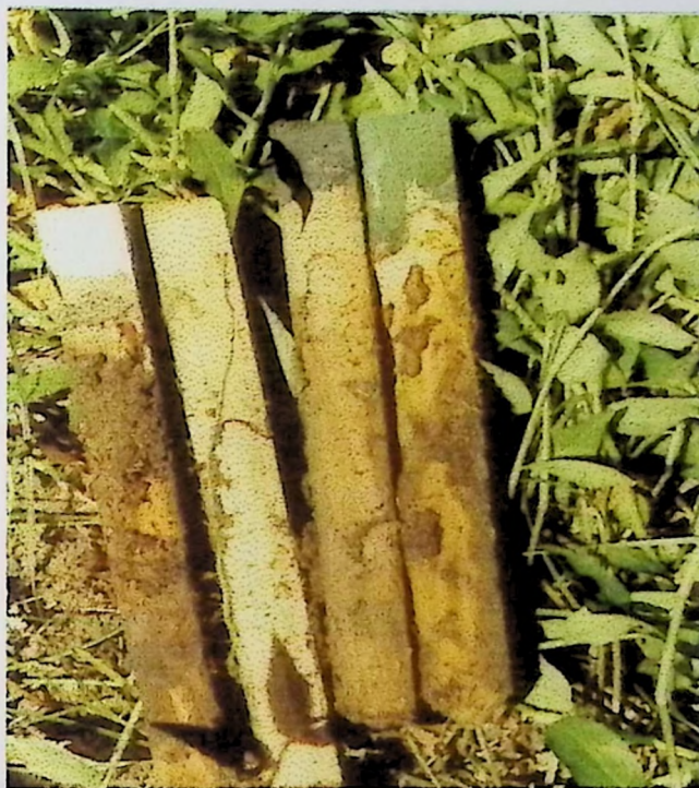
Figura 12. Amostras de Eucalyptus robusta (ponta branca), Pinus sp. (sem cor), E. pellita (ponta preta) e E. urophylla (ponta verde) infestadas por Nasutitermes nordenskiöldi . Seropédica, RJ. 2000.
