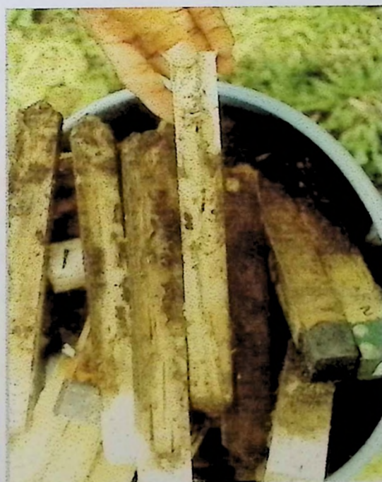
Figura 9. Amostras infestadas por Coptotermes havilandi . Seropédica, RJ. 2000.
