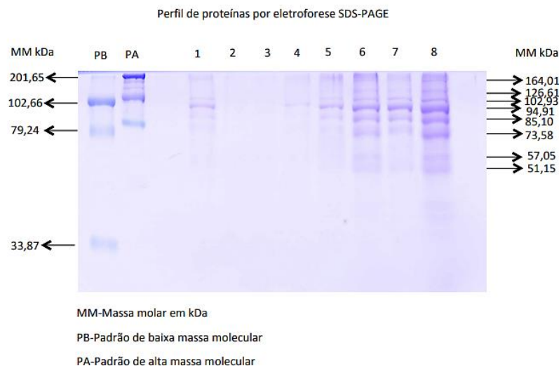
Figura 7 - Perfil de identidade eletroforético (10% acrilamida) das amostras de macarrão, sem glúten, submetidas a diferentes tratamentos em relação às proporções de arroz e grão de bico, após extração de suas proteínas hidrofóbicas com álcool 70%
