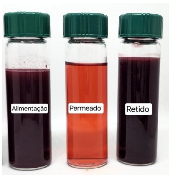
Figura 9. Frações do processo de concentração por nanofiltração em espiral do suco de amora
