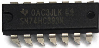
Figura 21. Circuito integrado SN74HC393N. Fonte: Acervo fotográfico do Autor.
