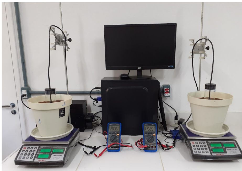
Figura 34. Montagem do sistema para calibração da sonda. Fonte: Acervo fotográfico do Autor.
