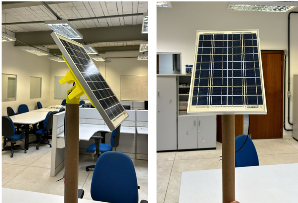
Figura 26. Paine Solar para alimentação energética da sonda. Fonte: Acervo fotográfico do Autor.
