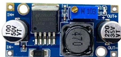
Figura 32. Regulador de tensão modelo LM2596 Step-Down. Fonte: Acervo fotográfico do Autor.
