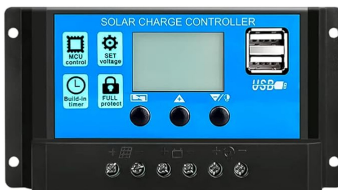
Figura 29. Controlador de carga para painel solar Knup AD60A. Fonte: Acervo fotográfico do Autor.
