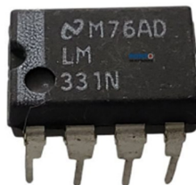
Figura 22. Circuito integrado LM331. Fonte: Acervo fotográfico do Autor.
