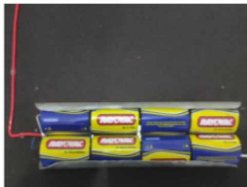
Figura 9. Detalhe das pilhas/gerador ampliado (acervo do autor)
