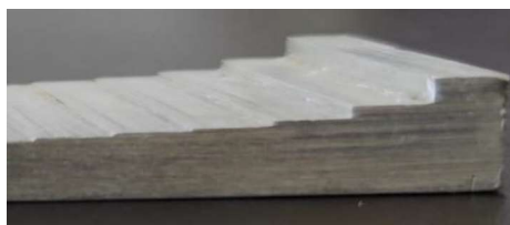
Figura 2: Vista lateral do penetrômetro destacando degraus com espessuras crescentes (Fonte: arquivo pessoal).
