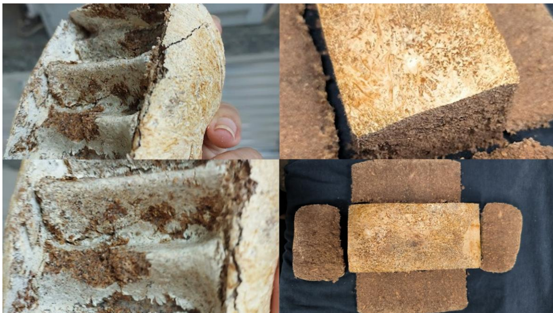
Figura 9: Ajustes no processo de desenvolvimento do Biomaterial. Colonização incompleta no interior.
