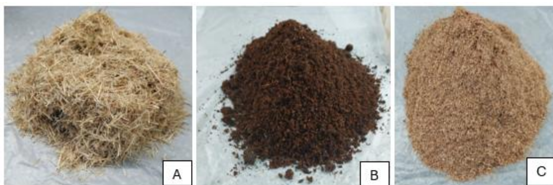
Figura 5: Substratos utilizados na produção dos biomateriais. A: Capim, B: Fibra de coco, C: Serragem de Eucalipto e Pinus.
