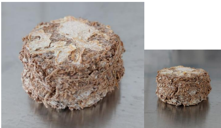
Figura 14: Deformação da amostra de Pleurotus ostreatus após análise.
