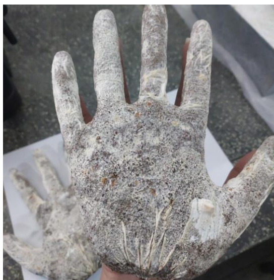
Figura 13: Formato obtido através do processo de moldagem, biomaterial a base de micélio de Ganoderma lucidum .
