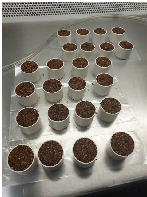
Figura 6: Molde elaborado a partir de tubo de pvc, com substrato previamente colonizado.
