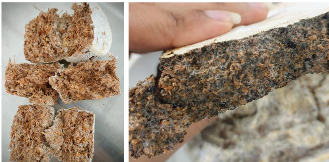
Figura 10: Ajustes no processo de desenvolvimento do Biomaterial. Colonização ocorrendo na parte interior.
