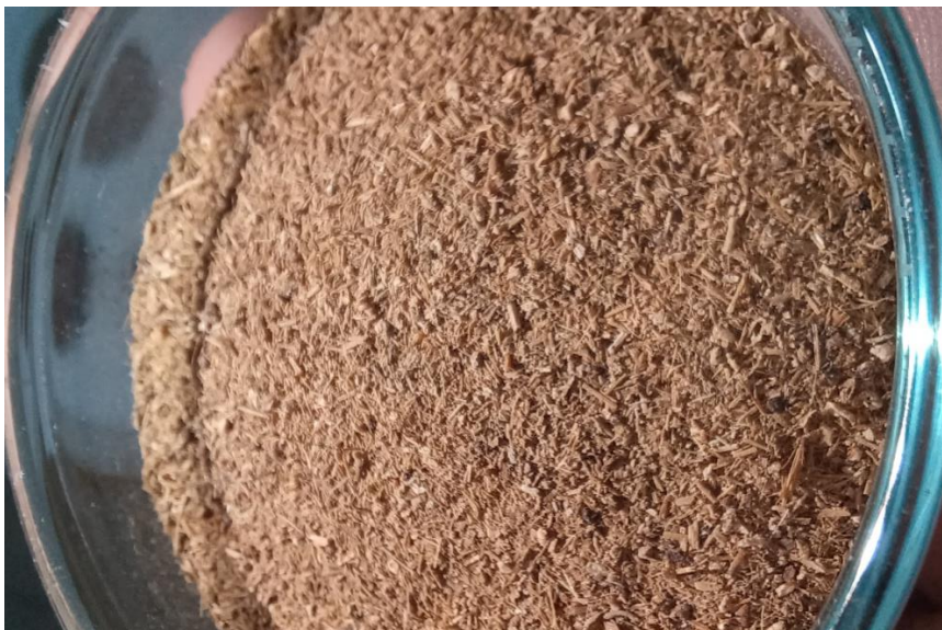
Figura 12. Aspecto do CEC após processamento em um moinho de facas. Fonte: autor, 2025.
