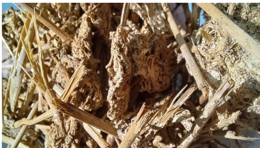
Figura 11. Composto exaurido de cogumelo (CEC) após secagem Fonte: autor, 2025.
