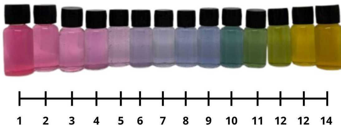
Figura 7. Alterações de cor do PLBD em diferentes valores de pH
