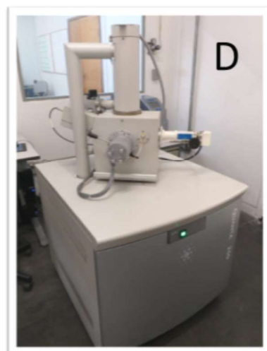
Figura 5: Parte da preparação de amostras realizada no LGPA - UERJ (a e b) e no MULTILAB – UERJ (c e d). a) Separação por líquidos densos. b) Separador Frantz. c) Lupa para catação manual dos grãos e montagem da resina epóxi. d) MEV para imageamento dos grãos de zircão.
