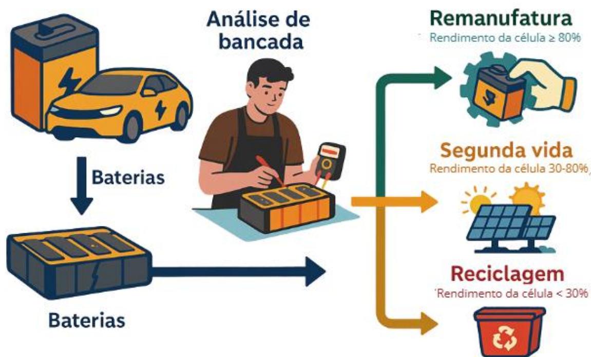
Figura 7. Esquematização da proposta de logística reversa para baterias de veículos elétricos no Brasil em uso
