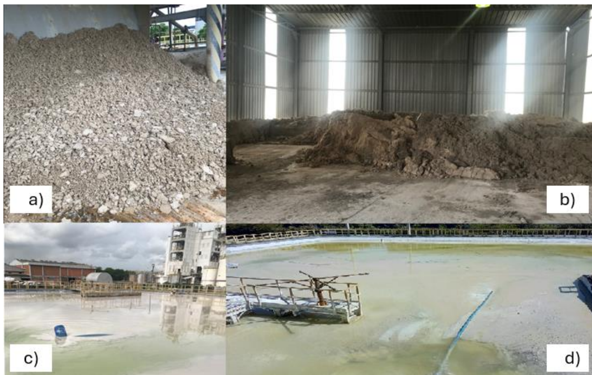
Figura 9 - Geração do RPC na FCCSA em a) a torta do RPC após saída do filtro prensa, em b) desidratando em galpão coberto e em c) e d) apresenta o RPC nas bacias de decantação de sólidos.
