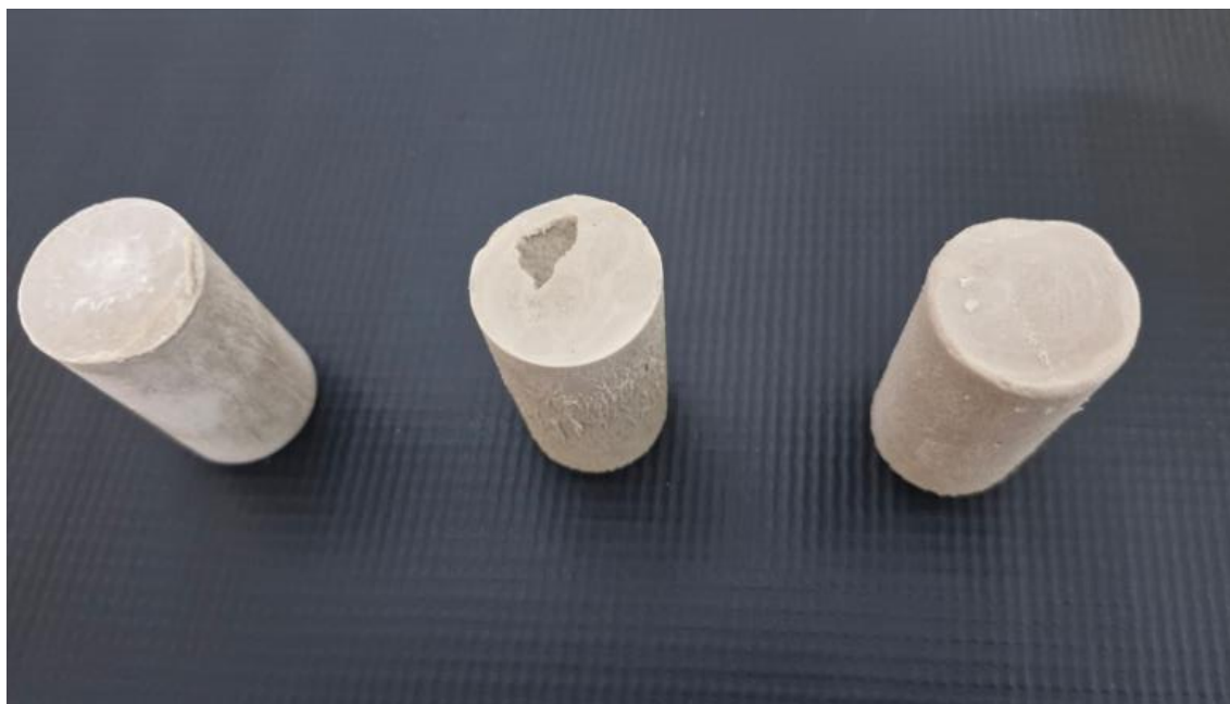
Figura 30 - Formulação de 75% de RPC com geopolimerização comprometida.
