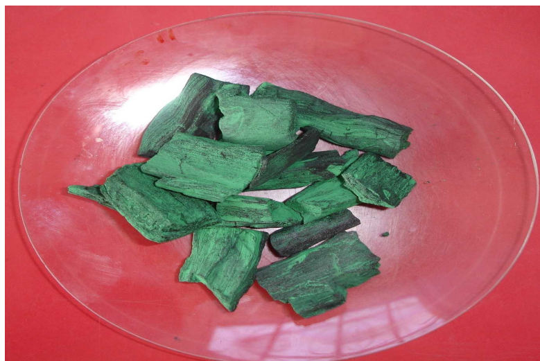
Figura 5 - Amostra de carvão impregnado com pigmentos coloridos, comprovando a capacidade absorção/adsorção, principalmente dos carvões ativados.
