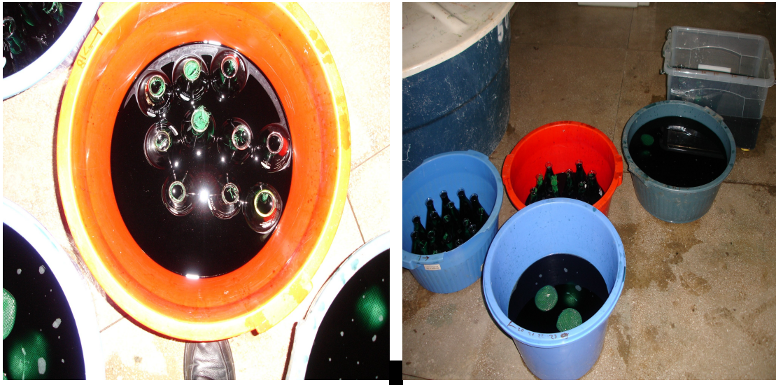
Figura 4 - Ensaio de absorção/adsorção de pigmentos coloridos, com os carvões vegetais ativados e não-ativados.
