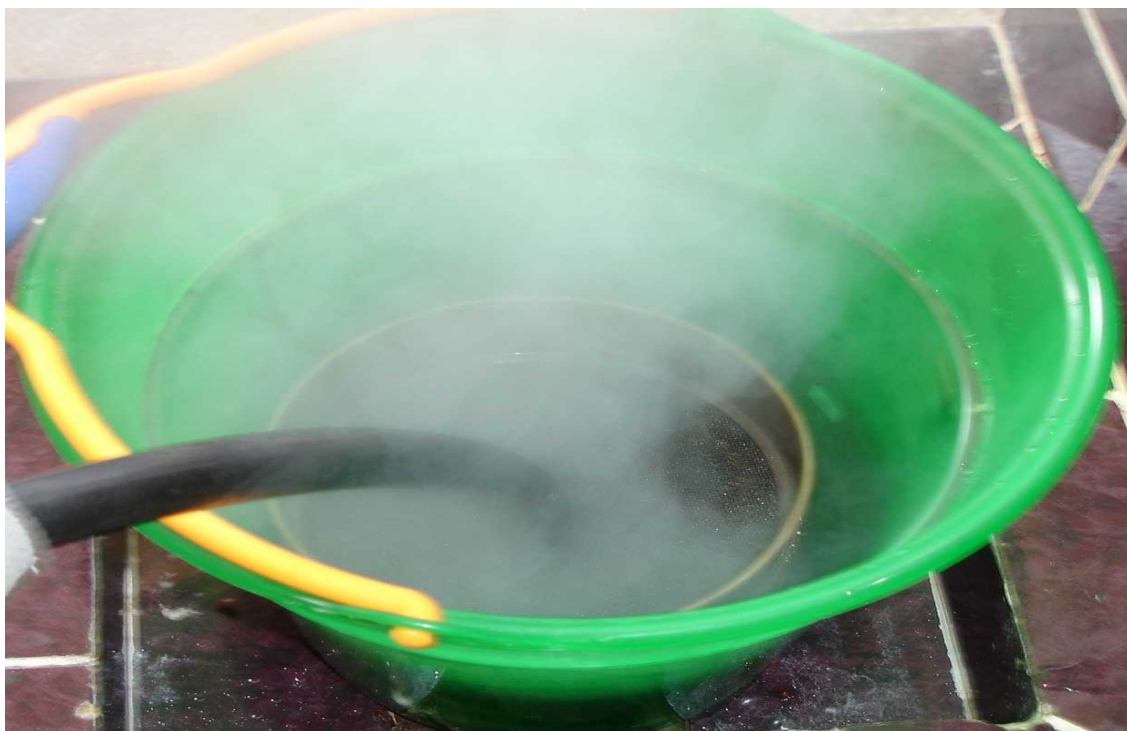
Figura 3 - Peneiras instaladas dentro de um recipiente e recebendo a aplicação do vapor superaquecido, possibilitando a ativação dos carvões.
