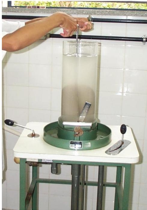
Figura 4 - Formação da folha-teste na Coluna Formadora TAPPI.
