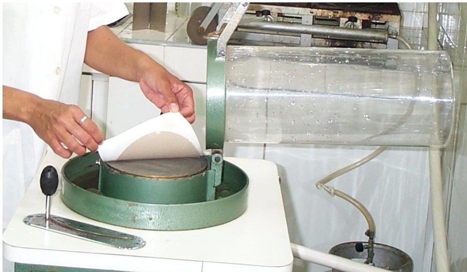
Figura 5 - Utilização de um papel mata-borrão para a retirada da folha-teste da Coluna Formadora TAPPI.
