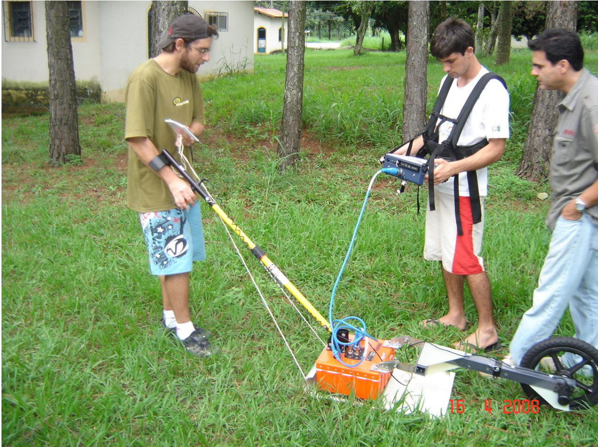
Figura 1: GPR montado e pronto para ser utilizado.
