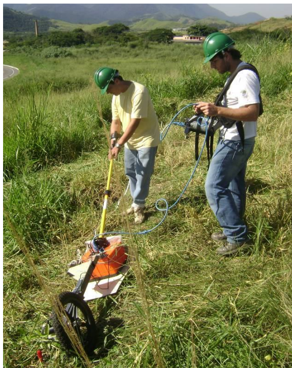
Figura 3: Utilização do Georadar em área de Neossolo Regolítico.
